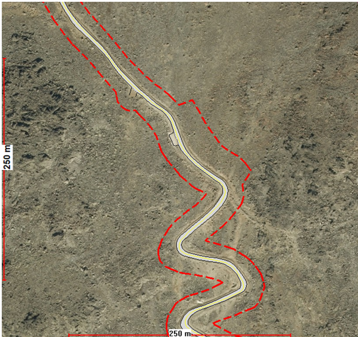
Fig. 4: Forekomst av morenemasse til høyre for øverste sving, med 15 meter ekstra planavgrensning for videre vurdering. Bløte morenemasser vil kunne ha egenskaper som egner seg spesielt godt til dekke når det tørker og stivner.
