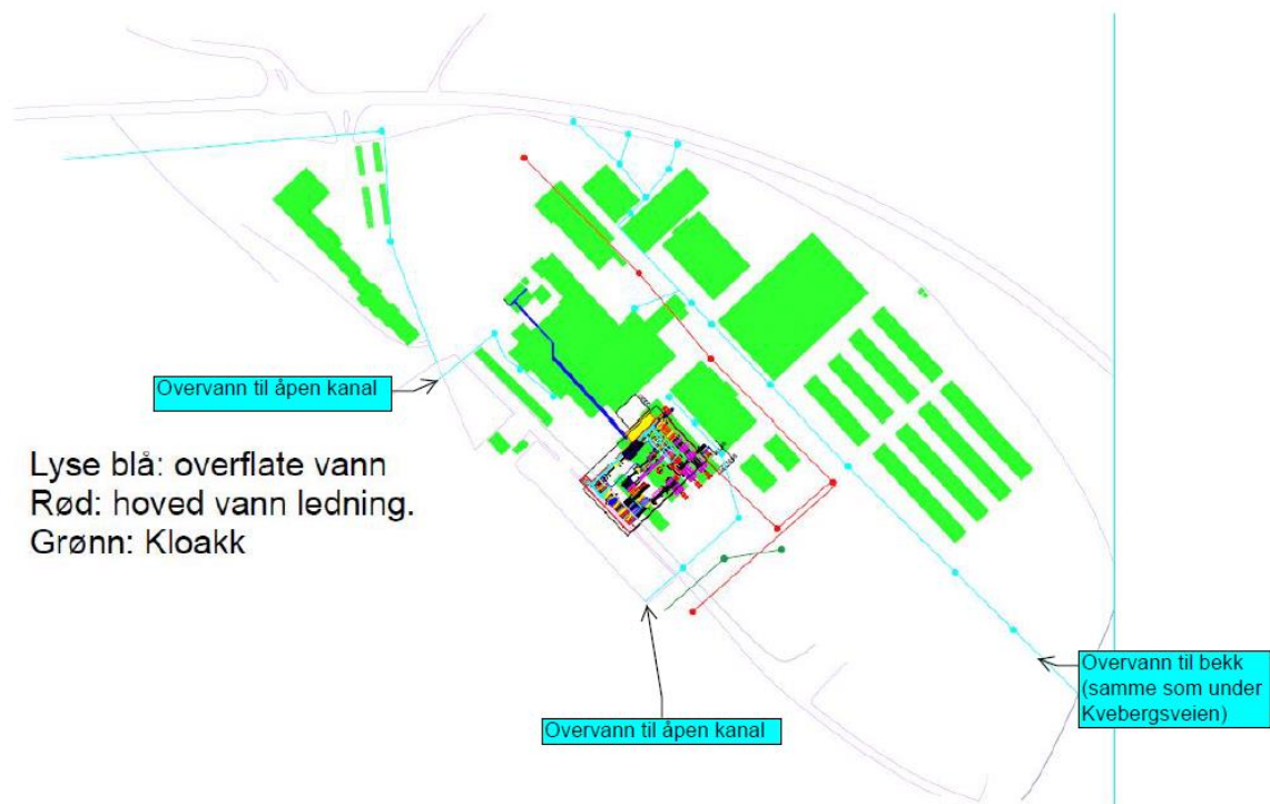
Utsnitt kart overvannsløsning etablert av Alvdal Skurlag
