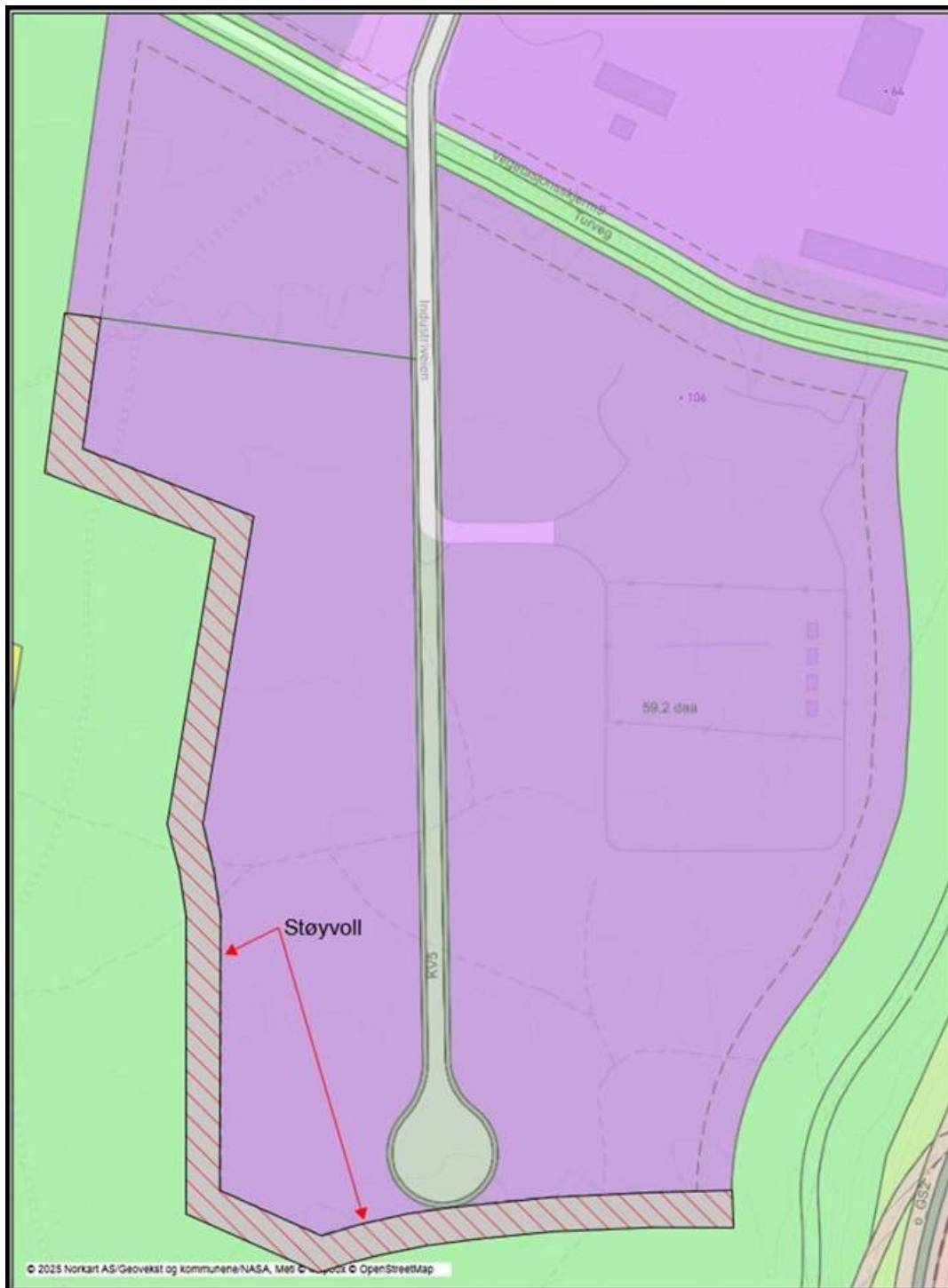
Fig.2. Situasjonsplan for omsøkt skjermings-voll, tegnet på kartet for reguleringsplan for Plassen Industriområde, søndre del (I3).
